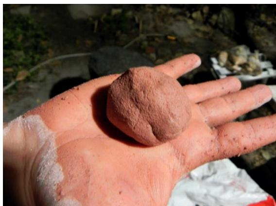
Após fazer o teste acima corrija o solo utilizado para que ele mantenha as proporções desejadas, conforme as técnicas descritas abaixo.
