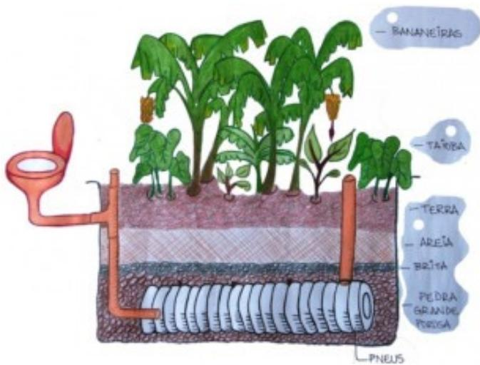
plantas. A água que é utilizada no sistema evapora da terra ou através da transpiração das plantas, voltando limpa ao ambiente.
