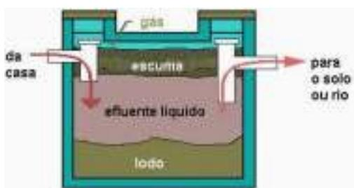
A fossa séptica, bastante difundida atualmente, é muito funcional como um primeiro estágio para redução da matéria orgânica no sistema. As águas residuais se separam em camadas e começam seu processo de decomposição. As bactérias presentes no sistema passam a digerir os sólidos transformando-os em líquidos ou gases. Por não metabolizarem todos os materiais presentes no sistema, é fundamental que periodicamente os sólidos acumulados sejam retirados.
