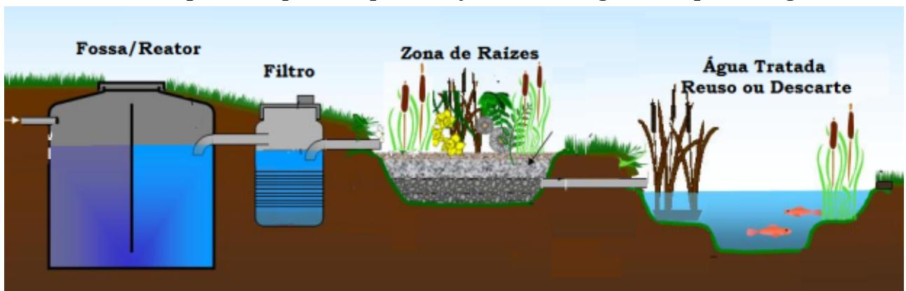
O processo de biorremediação se dá pelo fato de microrganismos, como as bactérias, utilizarem substratos orgânicos e inorgânicos, como exemplo o carbono, como fonte de alimentação. Desta forma, convertendo os contaminantes em CO<sub>2</sub> e H<sub>2</sub>O.
